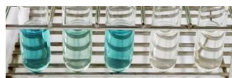
図7 ABTS法による10倍希釈試料の抗酸化活性測定(左からC, S1, S2, S3, S4 尚Cは試料のかわりに蒸留水を同量添加し対照とした)
