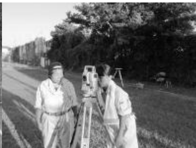
トータルステーション操作
